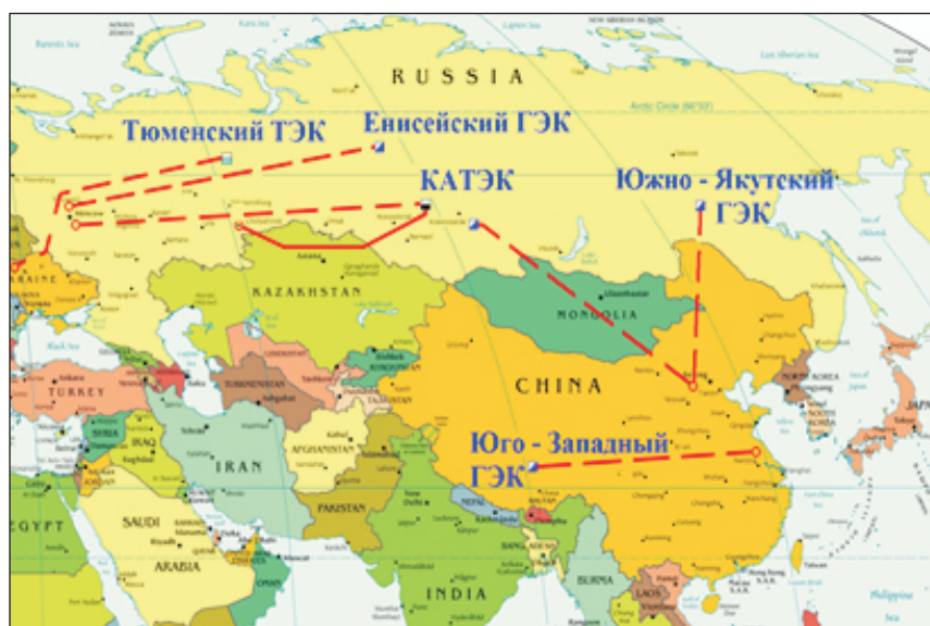
Рис. 4. Гипотетическая модель связи на базе ВЛ 1150 кВ в Евразии
