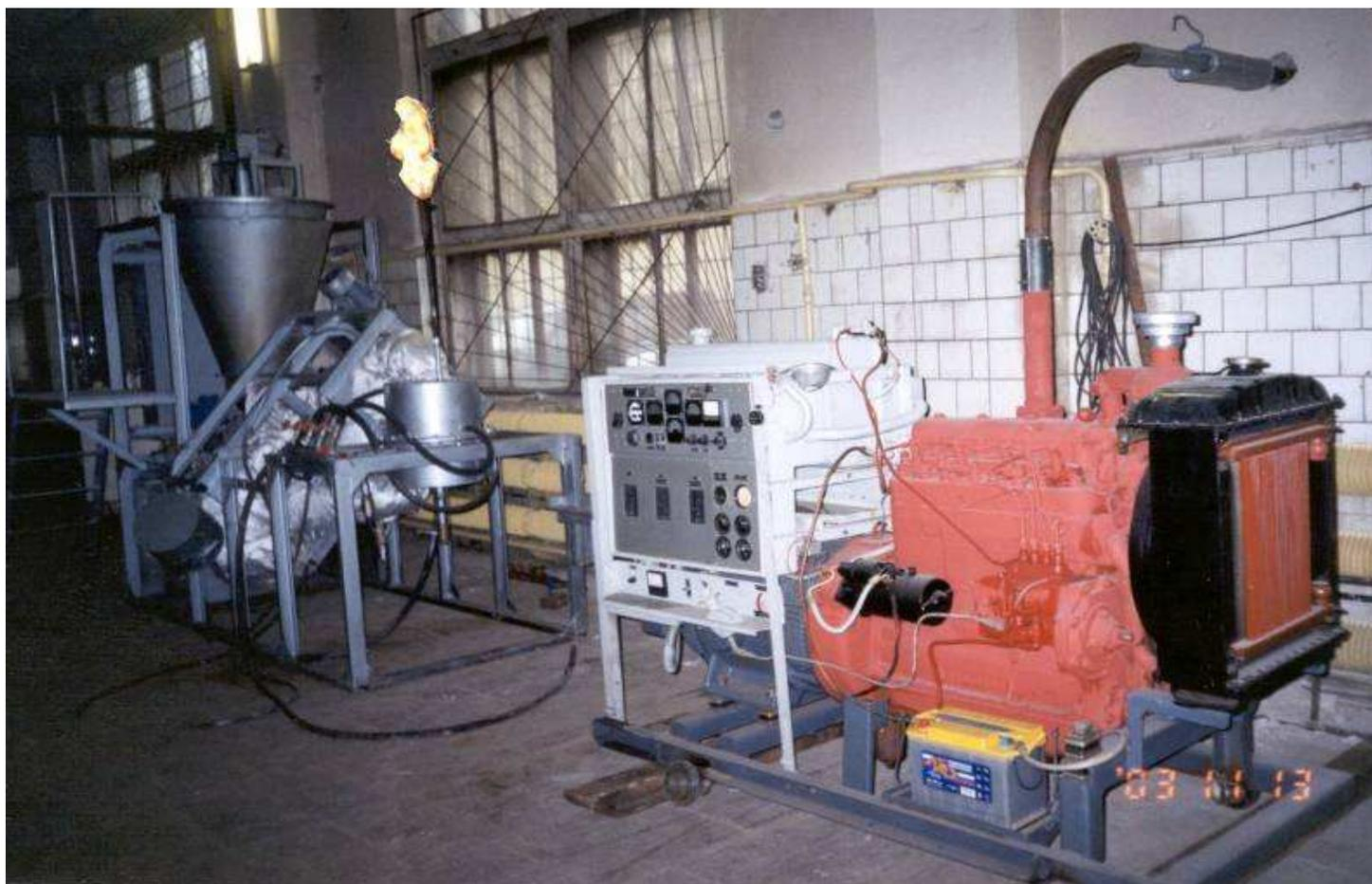
**Образец мини-ТЭС электрической мощностью в диапазоне 30-100 кВт с модулем пиролиза производительностью 1 тонна растительного сырья в сутки**
