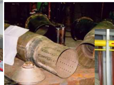
Жаровые трубы растопочных камер на дизельном топливе
